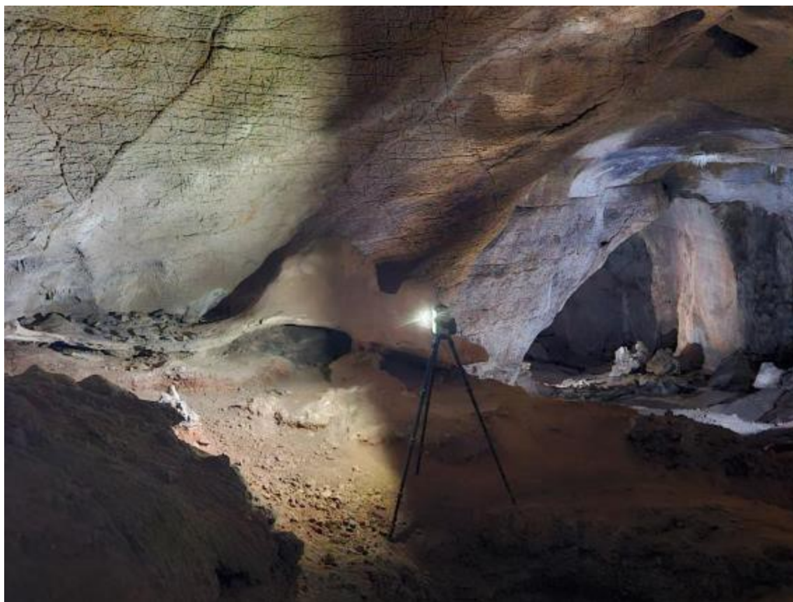
Figura 11.- Sistema d'il·luminació frontal muntat en el escàner per a la il·luminació directa per a les fotografies que pren l'escàner làser.
