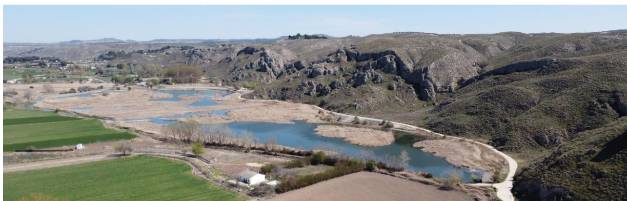
FIGURA 4. Vista aérea (Dron) de la zona de falla que define los escarpes en yesos de la margen izquierda del Tajuña en el entorno del Espacio Natural Protegido de la Laguna de San Juan (Chinchón). En la vista también se observa la parte superior del escarpe libre de la línea de fractura y las importantes formaciones coluvionares que se generan a su pie.
