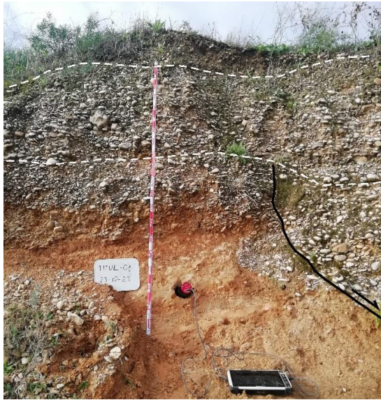
FIGURA 2. Detalle de las deformaciones sinsedimentarias en la terraza de +10 m del Tajuña en las proximidades de Titulcia durante su muestreo para datación OSL.
