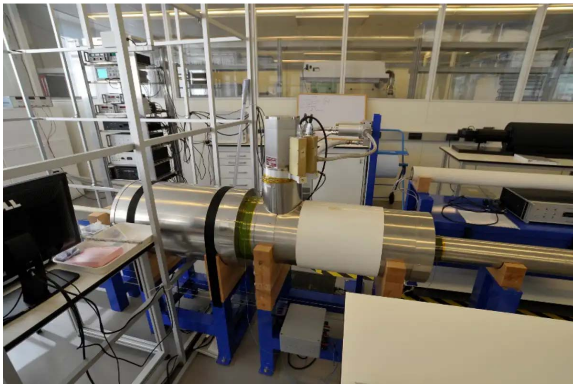
Magnetómetro criogénico en el laboratorio de Arqueomagnetismo del CENIEH, Burgos. Josep M. Parés, Author provided
